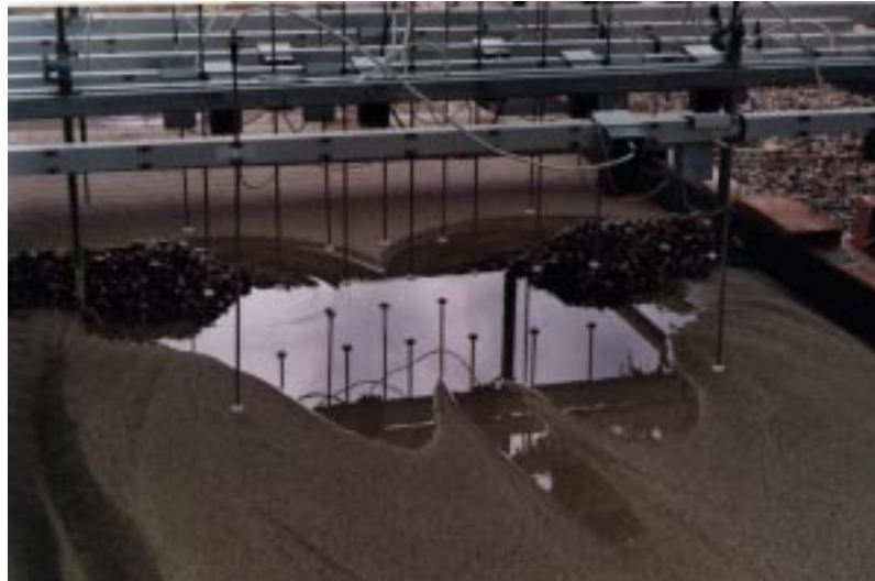
Figura 10. Configuración final del ensayo de la evolución de erosión en la construcción de espigones. Obsérvese la simetría del ensayo.
